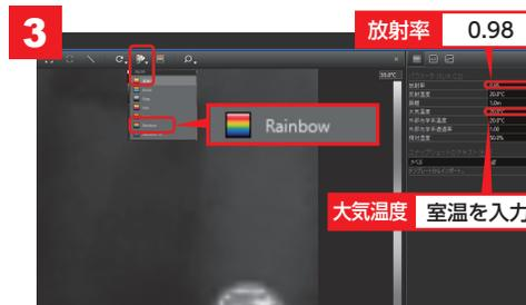
パレットツールをクリックして色表示を「Rainbow」変更し、大気温度（室温）を入力する。人を計測する場合は放射率を0.98と入力する。
