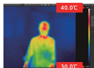
カラーバーの温度入力範囲を上を40.0°C 下を30.0°Cに設定すると40.0°C～30.0°Cの温度帯の物体のみ表示されます。流動的な対象物の温度を測るのに適しています。
