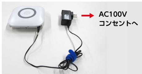
上のように AC アダプタを接続すると本体の電源が入ります。起動中はセンターランプがブルーに点滅しています
