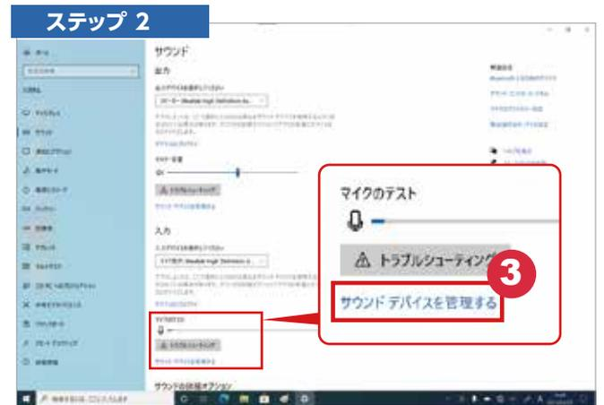
Windows 設定のサウンドが表示されマイクテストの「サウンドデバイスを管理する」**③**をクリックする
