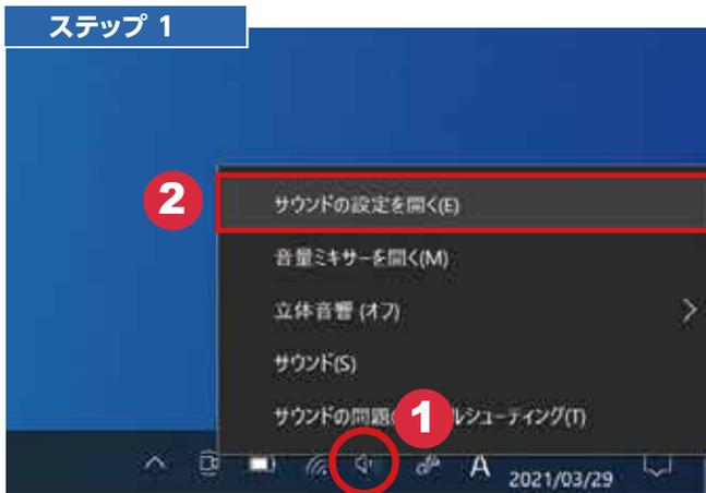
タスクバーの「スピーカーアイコン」**①**を右クリックし、「サウンドの設定を開く」**②**をクリックします。
