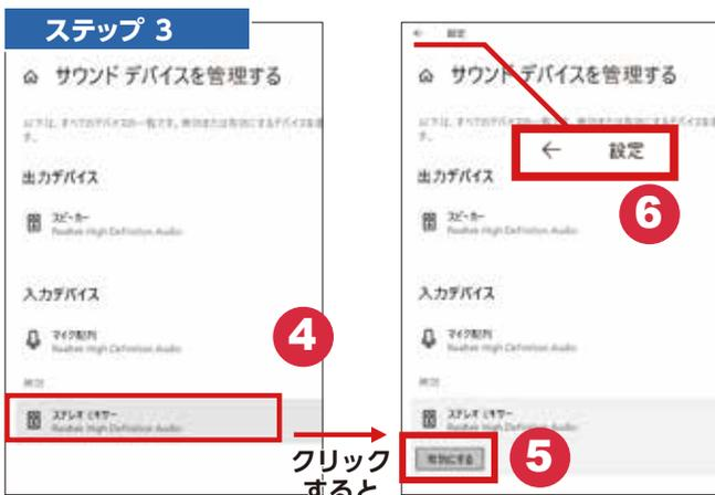
「ステレオミキサー」**④**をクリックすると「有効にする」と表示され「有効にする」**⑤**をクリックし、設定**⑥**をクリックしてサウンドの設定画面に戻ります。
