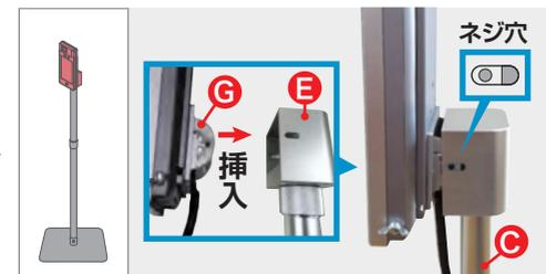
[G] 接続台を、[E] ヘッド部の内部にネジ穴が合うようにはめます。※電源ケーブルを圧迫しないようご注意ください。
