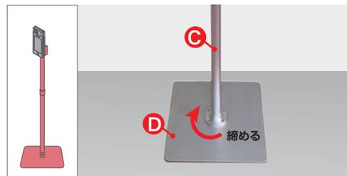
[C] 伸縮パイプと [D] 土台のネジ部を合わせて締めます。※溝が細いので回転数は多めです。
