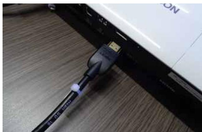
プロジェクターに接続した HDMI ケーブルに更に AV アダプタを連結すれば自動的に iPad の画面がそのまま投影されます。もし、映像が切り替わらない場合はプロジェクター側の「自動検出ボタン」を押して接続を認識させて下さい。
